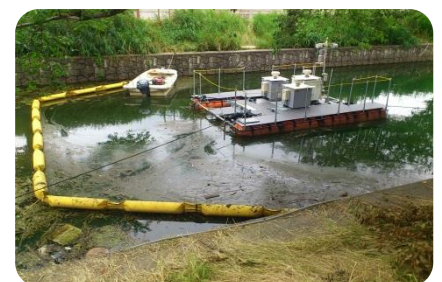
アオコ抑制装置の設置・運転
