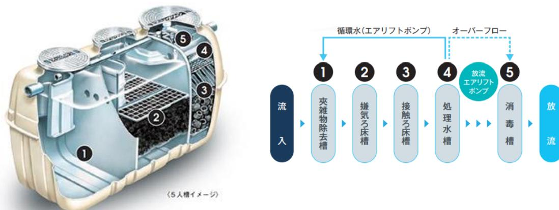
図3. 4. 1 小規模浄化槽の間欠ばっ気導入製品事例1（フジクリーン工業(株)）
